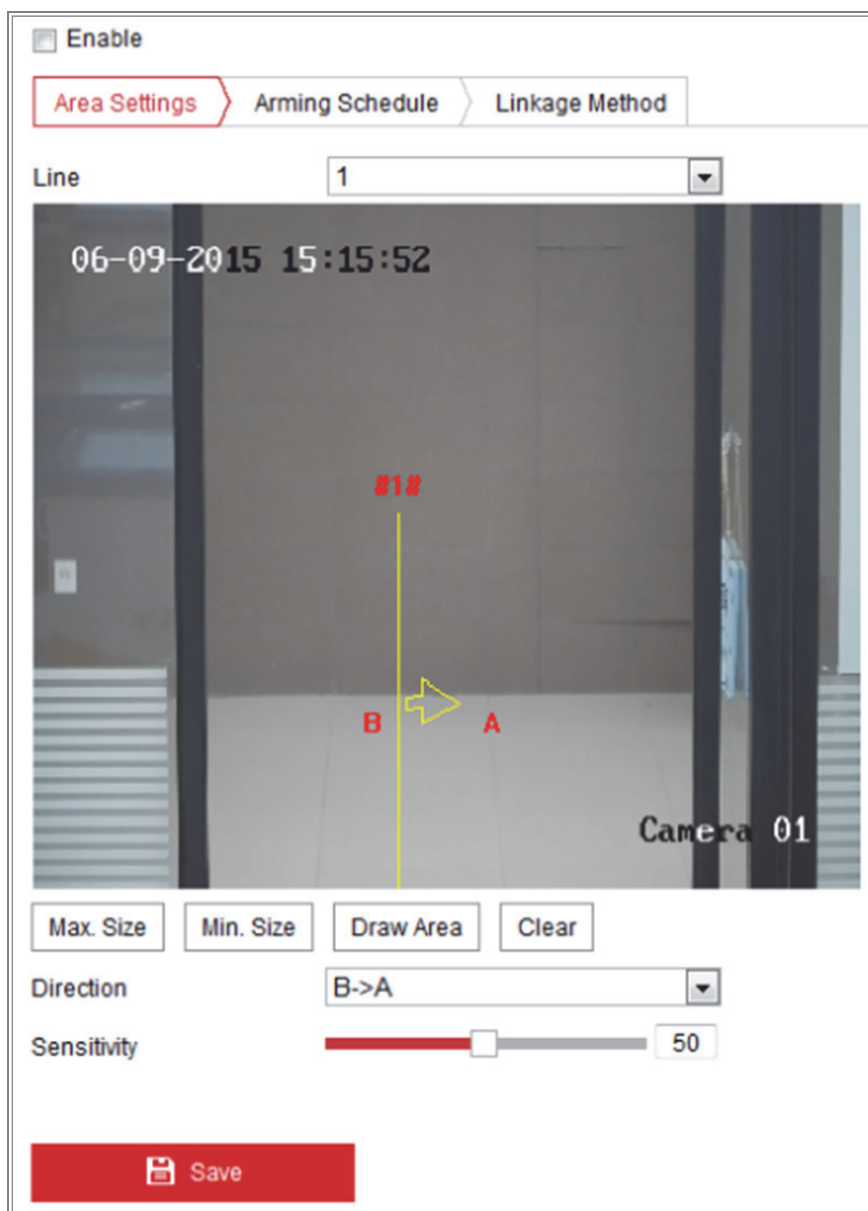
Rysunek 10–20 Detekcja przekroczenia linii
