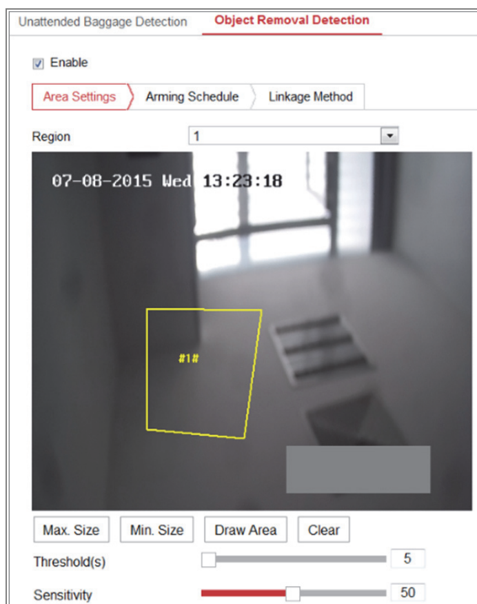
Rysunek 10–24 Detekcja usunięcia obiektu
