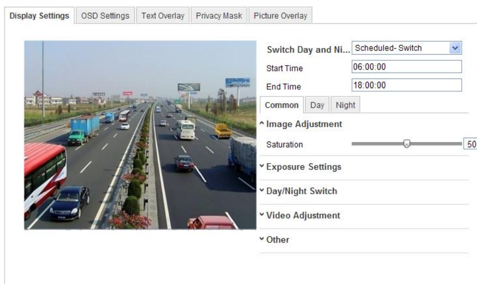
Rys. 6–37: Interfejs ustawień funkcji PRZEŁĄCZANIA TRYBU REJESTRACJI DZIEŃ/NOC — wariant z przełączaniem sterowanym za pomocą czasu ( Scheduled Switch )
